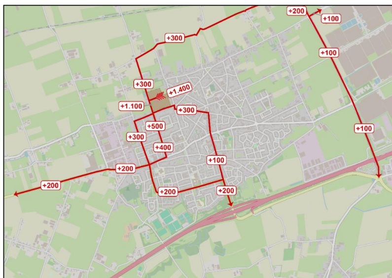
Figuur 3.1: Verkeersstoenames in mvt/etm in variant 1 t.o.v. de referentiesituatie 2040 (afgerond op 100-tallen en een ondergrens van 50 mvt/etm).
