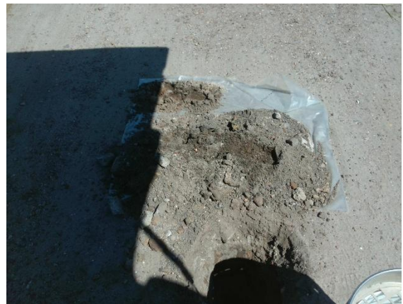
foto 6: Asbestinspectiegat deellootatie B: Vierendeelstraat en toegangsweg veldschuur
