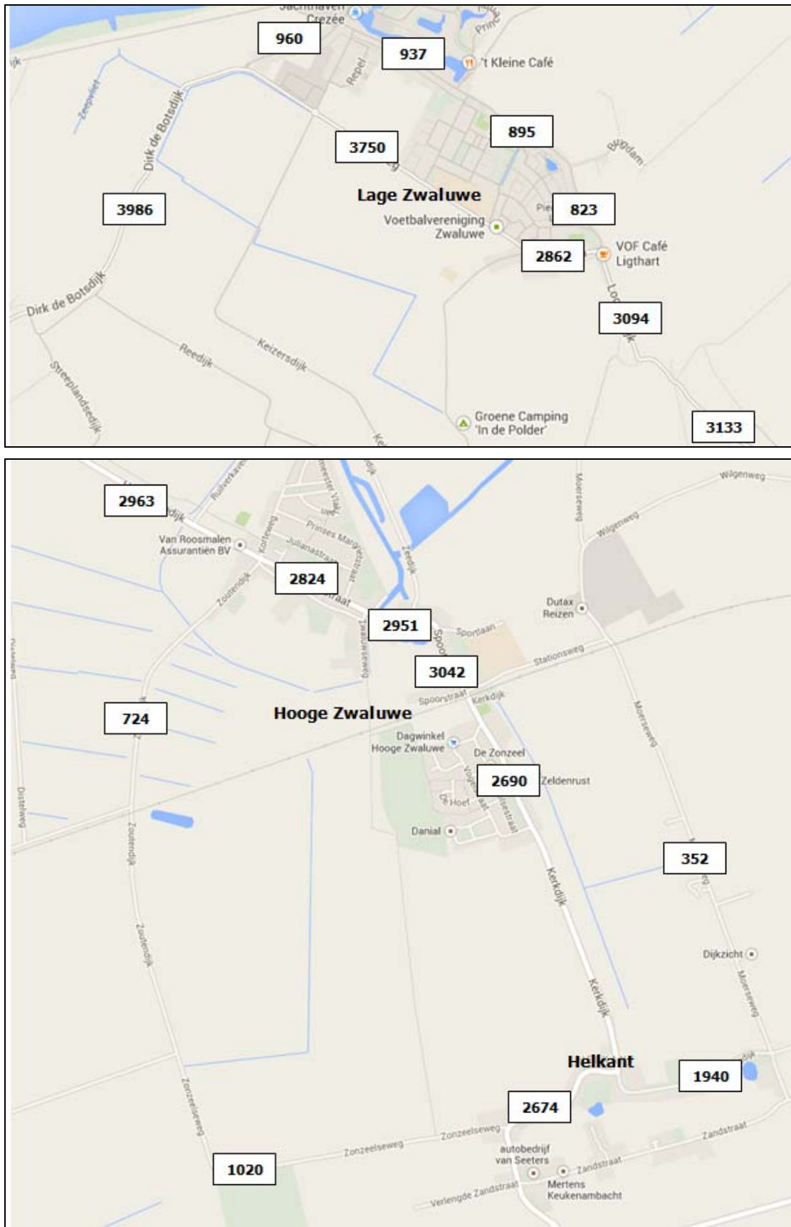
Figuur 4.2: gemiddelde werkdag-intensiteiten (uitgedrukt in motorvoertuigen per etmaal)
